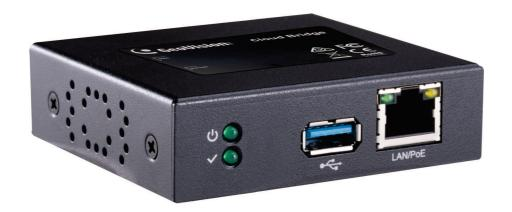
GV-Cloud Bridgeは、GeoVision製を含むONVIF対応カメラをGeoVision製ソフトウェアとモバイルアプリに接続し、監視と管理を統合するように設計されたエンコーダーです。
